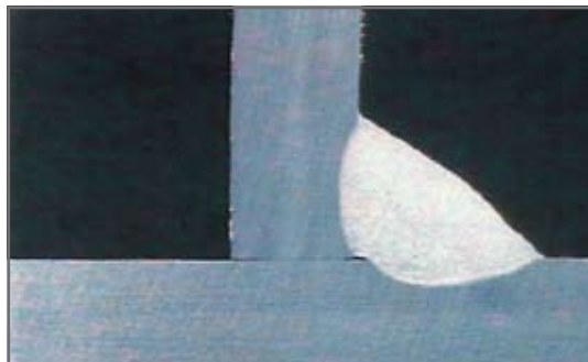
Argon 4.6 Werkstoff: Al Mg 4,5 Mn; Blechdicke: 5,2 mm; Schweißgeschwindigkeit: 40 cm/min; geringer Einbrand.
