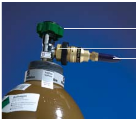
Flaschenventil Flaschen- ventilanschluss Ballongas- Füllstutzen
