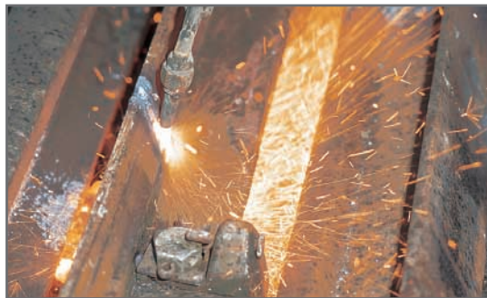
Hohe Schnittgeschwindigkeiten beim Brennschneiden.
