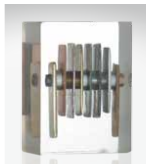
Korrosion im Kühlwasser.
